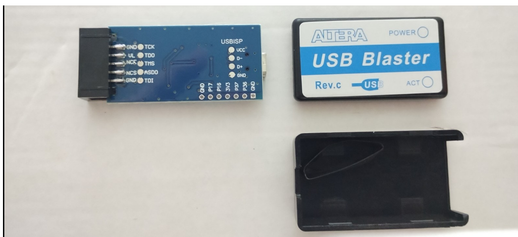
Obr. 7 – Spodná strana dosky: rad plošiek GND, P17, P16, 3V3, P37, P36, GND a plošky USBISP (VCC, D-, D+, GND). Foto: rtek1000/USB-Blaster_CH552 (MIT).
